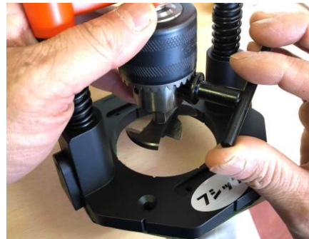
②三箇所締め付け
